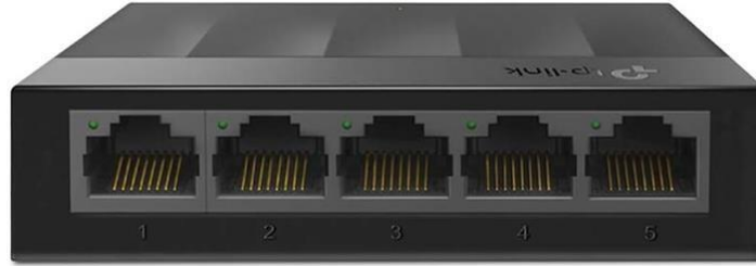
Şekil 13. CÜNAM ofis ve laboratuvar alanlarında çoklu bilgisayar ve ekipman kullanımını desteklemek amacıyla devreye alınan masaüstü gigabit Ethernet switch.
